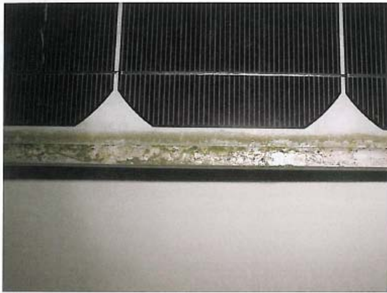
Bild 3. Schlechte Selbstreinigung bei geringer Neigung: Nach zweijährigem Einsatz bei einem Neigungswinkel von ca. 10° haben die Schmutzablagerungen am Modulrand bereits fast die untere Zellreihe erreicht
